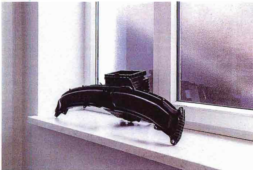
Dieser Luftleiter aus dem 5er BMW ist das größte bei Hachtel mit CT gescannte Einzelteil aus Kunststoff.
