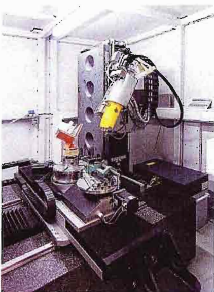
Mit der CT können Bauteile in Einbausituation geprüft werden: In dieser großen Anlage hat Hachtel schon komplette Spülmaschinen gescannt.
