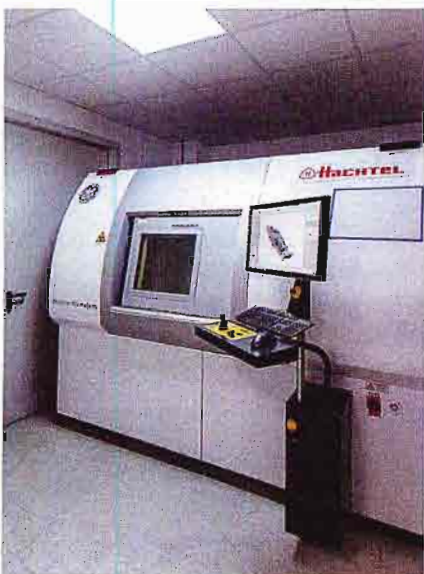
Je nach Größe des Bauteils und gewünschter Auflösung dauert ein dreidimensionaler CT-Scan zwischen 20 und 50 Minuten.
