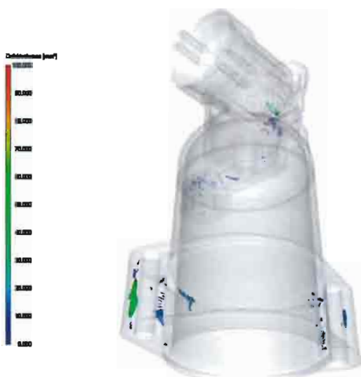
Defektanalyse an einem Stutzen für die Kraftstoffzufuhr: Die CT-Analyse macht Lunker und Poren sichtbar
