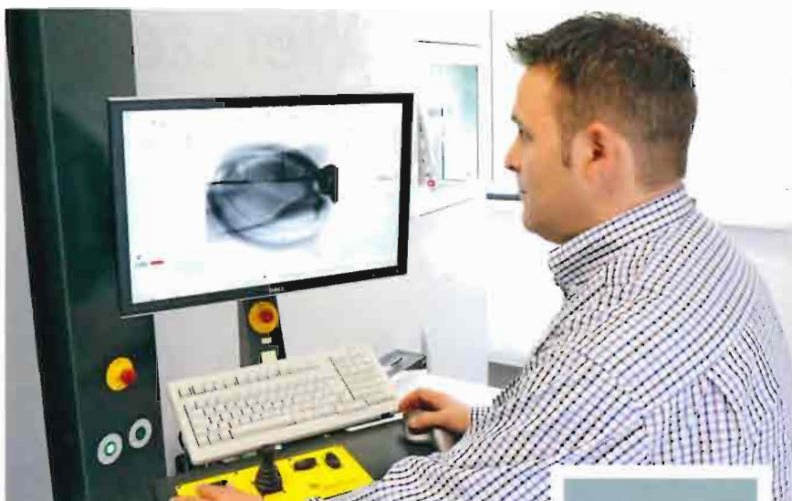
Der CT-Anlagenbediener bei Hachtel in Aalen bereitet den Scan eines Bauteils vor
