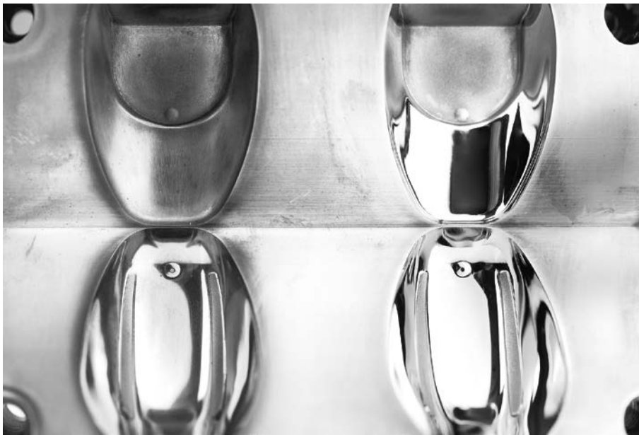
Höchste Oberflächengenauigkeit durch Polieren. Oben: Kavität vorpoliert (l.) und poliert (ohne Schichtsystem, r.); unten: nach Auftrag von Moldix mit leichtem Schmauch auf der Oberfläche (l.) und brillant mit Tiefenschärfe (r.) nach Hochglanzpolitur (© SK Poliertechnik Kaup)
